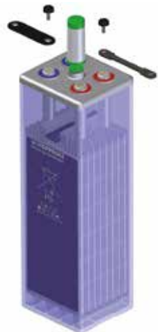
Abb. 5-17: Montage schraubbarer Verbinder
