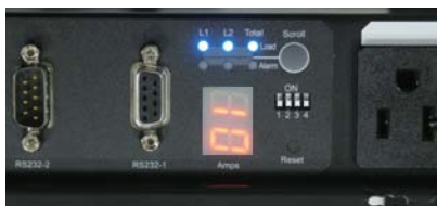
電流值與安全性告警顯示 可依PDU擺放位置而自動調整
